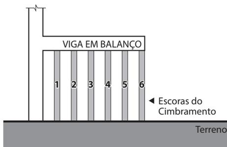
Analisar a figura e assinalar a alternativa que apresenta a ordem adequada para a retirada das escoras sob a viga em balanço.
